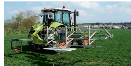
Mit diesem Ausleger kann gleichzeitig gesucht und gemäht werden.
